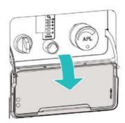
Ermöglicht die manuelle Beatmung des Patienten im Falle eines Systemausfalls (d. h. Netz- und Batteriebetrieb) oder eines anderen elektronischen Ausfalls und ist hinter der Abdeckung an der Vorderseite des Geräts zugänglich. Ersetzt den Frischgasfluss (mit 100 % O<sub>2</sub>) und die elektronische APL-Funktion
